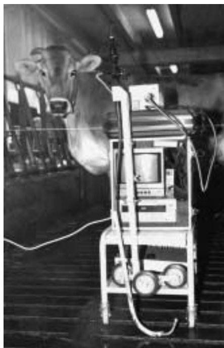
Fig. 6: Contrôle de l'état du caillebotis à l'aide d'un endoscope. L'objectif flexible est placé entre les fentes et fournit une bonne vue de la partie inférieure du caillebotis et des surfaces latérales.
